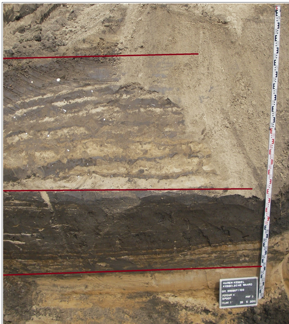
Figuur 5. Maren-Kessel, Kesselsche Waard: De bodemopbouw in het plangebied bestaande uit een grof gelaagd pakket bovenin, een fijn gelaagd pakket hieronder en onderin beddingzand van de Maas. Dit profiel is representatief voor het hele onderzoeksgebied.
